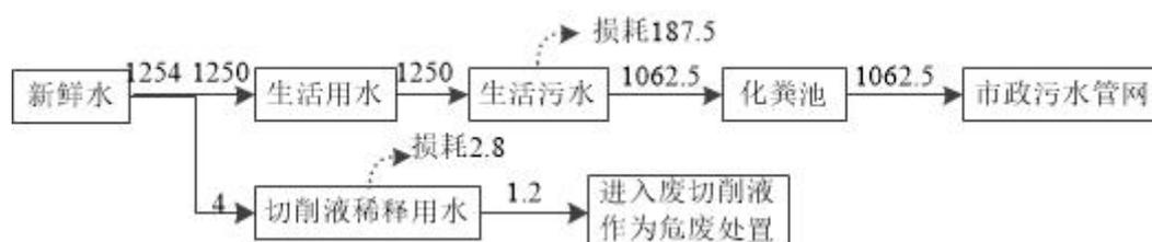
图 2.1-1 项目水平衡图 单位：t/a
